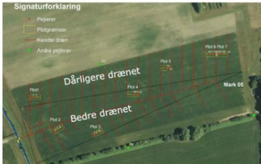
Figur 1. Forsøgsarealet med de syv plots, som repræsenterer forskellige afvandingsdybder.
